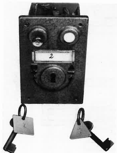
Foto 6 Prenosná výmenová zámka a prenosná uzamykateľná výmenová zámka
