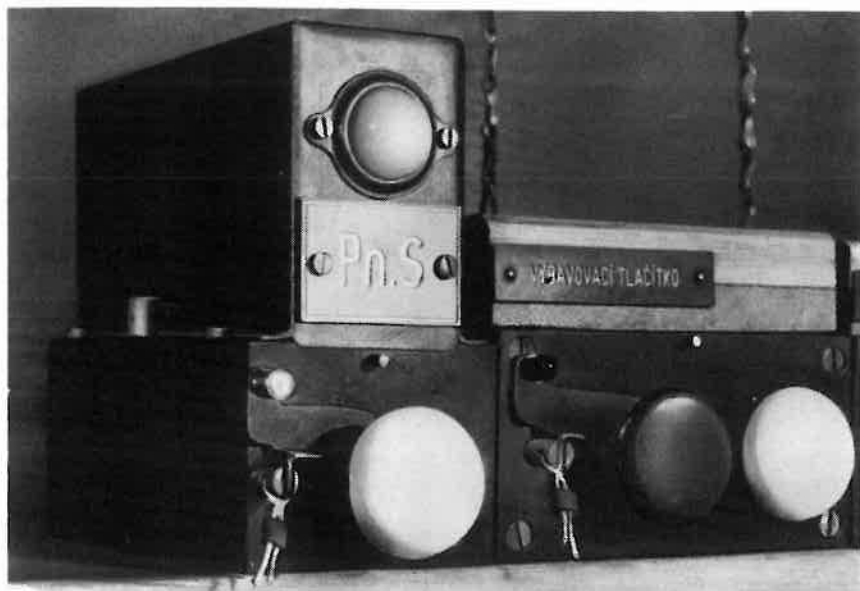
Foto 65 Tlačidlo privolávacieho návěstidla a vybavovacie tlačidlo
