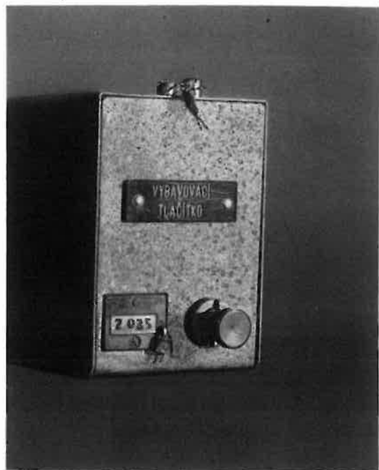
Foto 67 Vybavovacie tlačidlo s počítadlom
