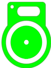
Obr. 2 Strana návestnej pomôcky pre denný znak návesti 114, Súhlas na odchod (zelená farba)
